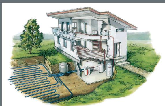
Существует много возможностей использования тепла из почвы, но самой эффективной из них является – непосредственное испарение. В этом случае агрегат теплового насоса как медиум переносит тепло в плоских коллекторах.
